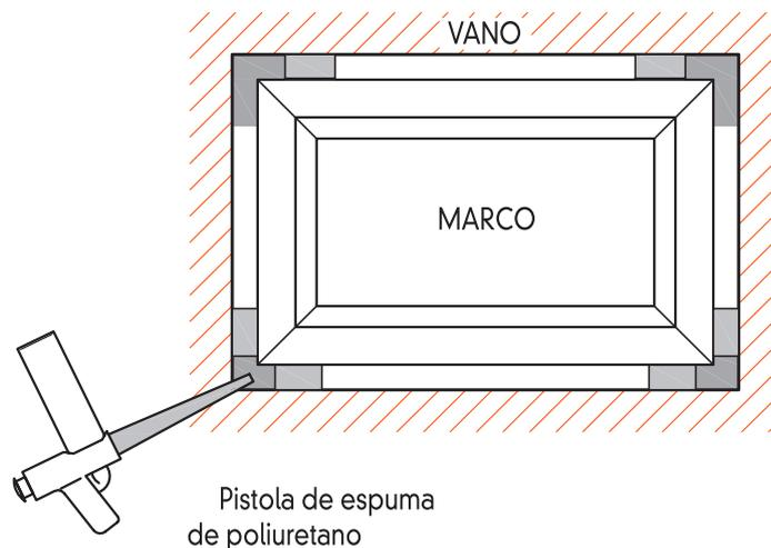
**13** Una vez seca la espuma, cortar en ambos lados del marco teniendo en cuenta que del lado exterior se dará una leve inclinación a la trincheta para lograr un mayor volumen de sellado.
